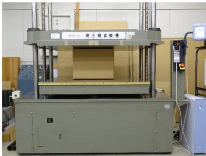
図1 圧縮試験機 (最大荷重 : 100kN)
